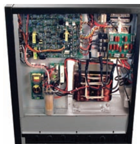
Изолирующий трансформатор, аккумуляторные батареи снизу в лотке
