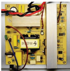
ИБП семейства LT оснащены зарядным устройством повышенной мощности вместо встроенных аккумуляторов
