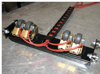
Токосъемная каретка для работы с двумя параллельно соединенными вариаторами (2 ролика на каждую дорожку)
